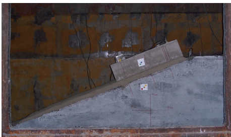
图 3 滑坡振动台物理实验模型图
