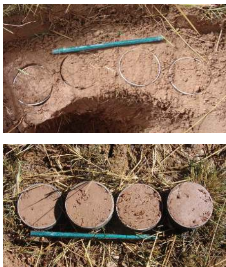
图 2 试验区 3 种草本植物根-土复合体试样原位制样过程
