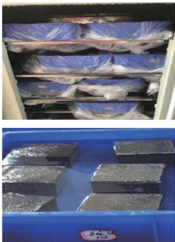
图 1 C-S 结石体侵蚀试验
