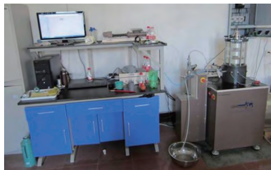
图 1 动三轴试验系统 DYNITS
