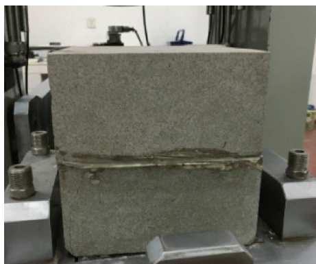
图3 人工节理面直剪试验
